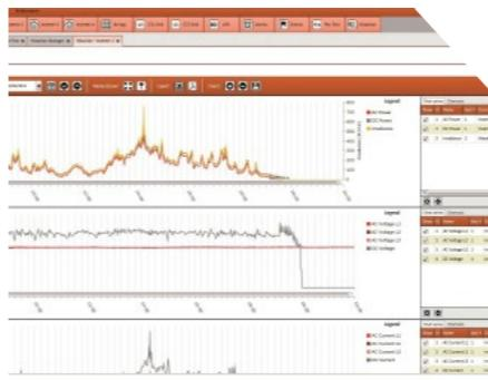
再生可能エネルギー発電の制御・監視のための電気的ソリューション(SCADA=監視制御・データ取得システム)
